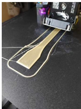
1. ábra – 3D nyomtatás folyamata saját fejlesztésű fa-polimer kompaunddal
