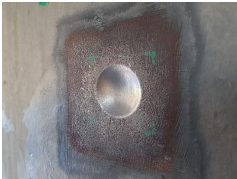
1. ábra – Sub-size mintavételi hely (bal), valamint a kivett minta és próbatestek (jobb)
