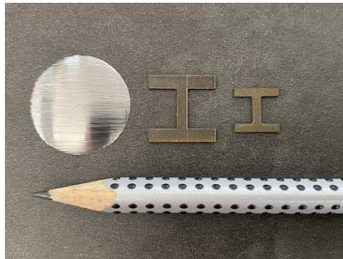
1. ábra – Sub-size mintavételi hely (bal), valamint a kivett minta és próbatestek (jobb)
